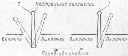
Рис. 73. Положение рычагов управления раздаточной коробкой
