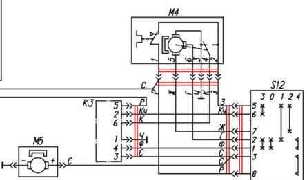
1. Сечение проводов - 0,75 мм<sup>2</sup>, кроме указанных на схеме.
